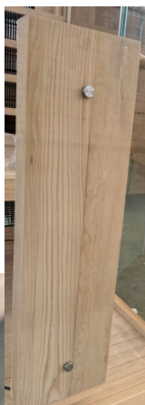
(7) Postavite prednja grelca in ju pritrdite z 4x20 vijaki
